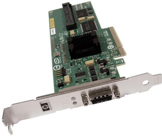
Ce composant est la carte RAID, elle permet de choisir une solution de stockage, la carte contient un système intelligent appelé raid qui permet de choisir plusieurs configurations pour sauvegarder ses données. Le choix devra être fait selon le besoin de l'entreprise ou du client et le niveau de sécurisation des données.
